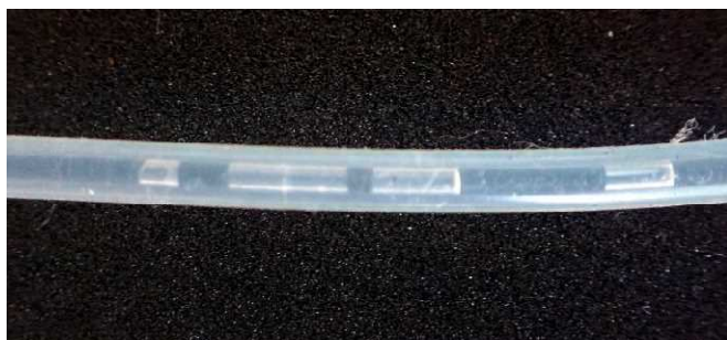
写真 疎水性キャピラリーの中で液体の水と共に安定して存在する常圧の水蒸気
